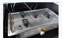
自动保湿清洗组件,保证清洗的稳定性,提供工作稳定性;
