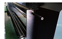
气涨轴后放后收装置,支持1000米的卷纸收卷
