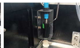
测高系统 测高，精准定位、高质量打印；
