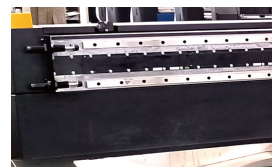
THK静音双导轨+磁悬浮 高速稳定打印，有效降低输出过程中产生的机械噪音，提高优质的工作环境；
