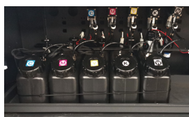
UV大墨桶 1.5L UV墨水专用存储桶，大容量墨桶，在打印过程中提供稳定供墨；
