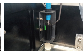
测高系统 测高，精准定位、高质量打印；
